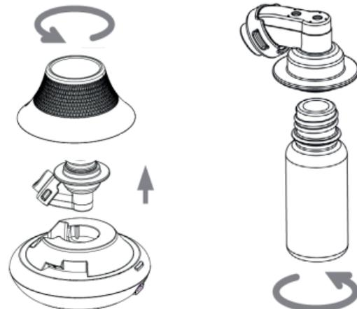
2. Drehen Sie die obere Abdeckung vom Gerät ab und entnehmen das Zerstäubungs-Modul aus der Basis.
