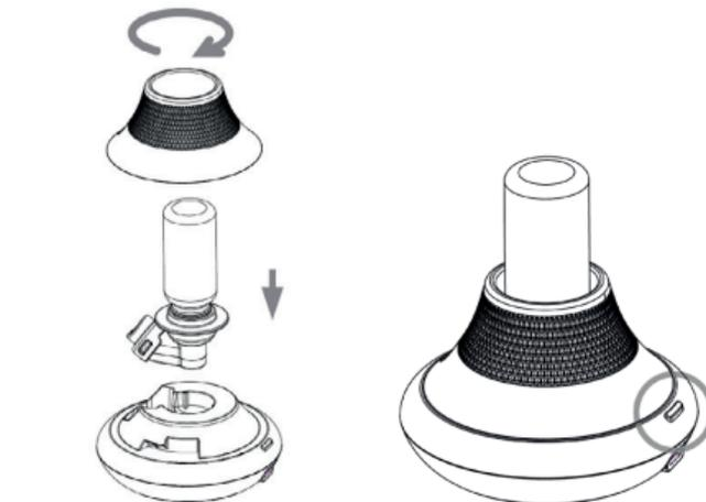
4. Stecken Sie das Zerstäubungs-Modul in die Basis und drehen die obere Abdeckung auf das Gerät, bis diese eingerastet ist.
